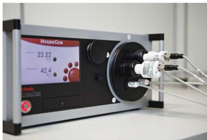
La calibración tanto en temperatura como en humedad se realiza en tres puntos de control crecientes y la repetición del punto medio para el control de la estabilidad.
