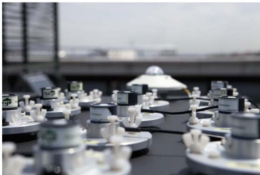
La verificación de los piranómetros se realiza bajo condiciones de luz natural con el fin de simular las mismas condiciones ambientales en las que trabajarán en campo, tomando datos de radiación siempre y cuando el ángulo solar sea superior a 20º y la radiación global superior a 300 W/m<sup>2</sup>
