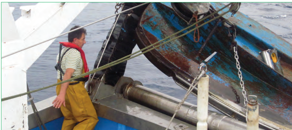
Arrastre: maniobra peligrosa de recuperación de las puertas deflectoras. Fuente: INSHT
