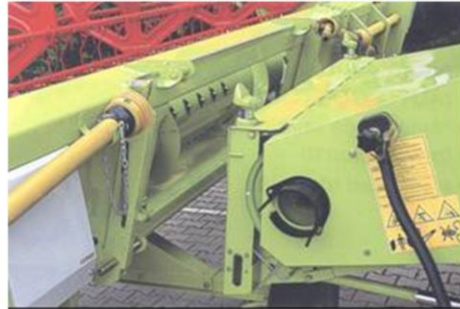
Enganche del cabezal al canal de alimentación
