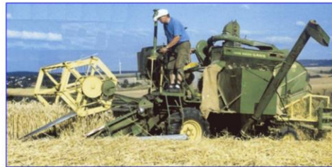
Cosechadora autopropulsada con ensacador (Lanz-John Deere)
