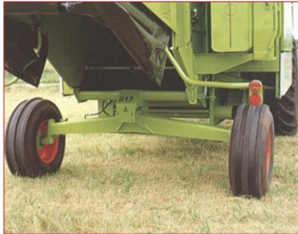
Eje trasero con apoyo central
