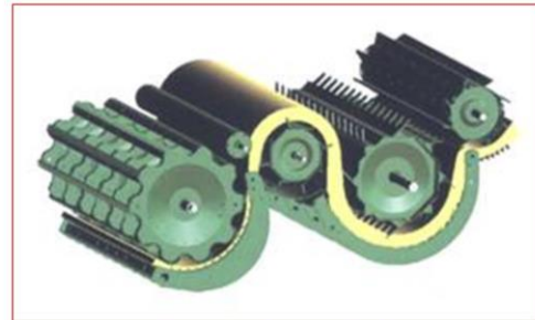
Separador rotativo con cilindro conductor
