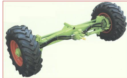
Eje trasero con ruedas motrices (transmisión hidrostática)
