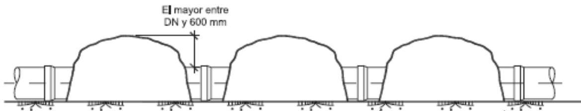
**Ilustración 33:** Recubrimiento parcial para evitar flotaciones.
