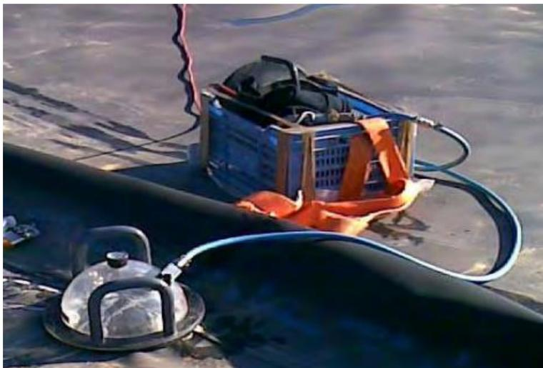
**Ilustración 45:** Ensayo de campana de vacío.
