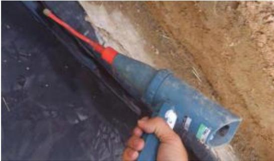
**Ilustración 42:** Ensayo de campana de vacío.
