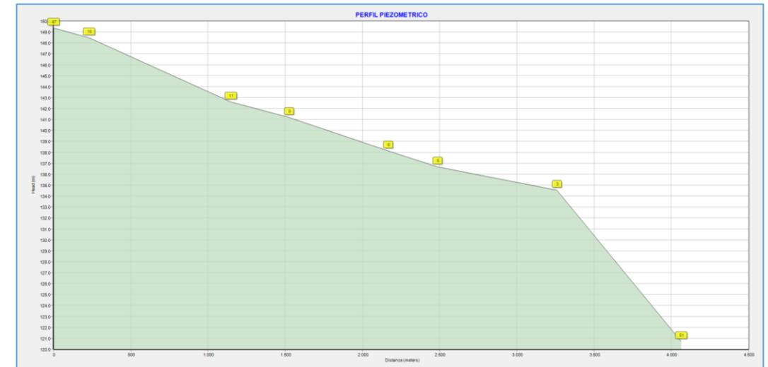
Se aprecia una caída pronunciada debido al cambio brusco de diámetro que afectará a la presión de bombeo.
