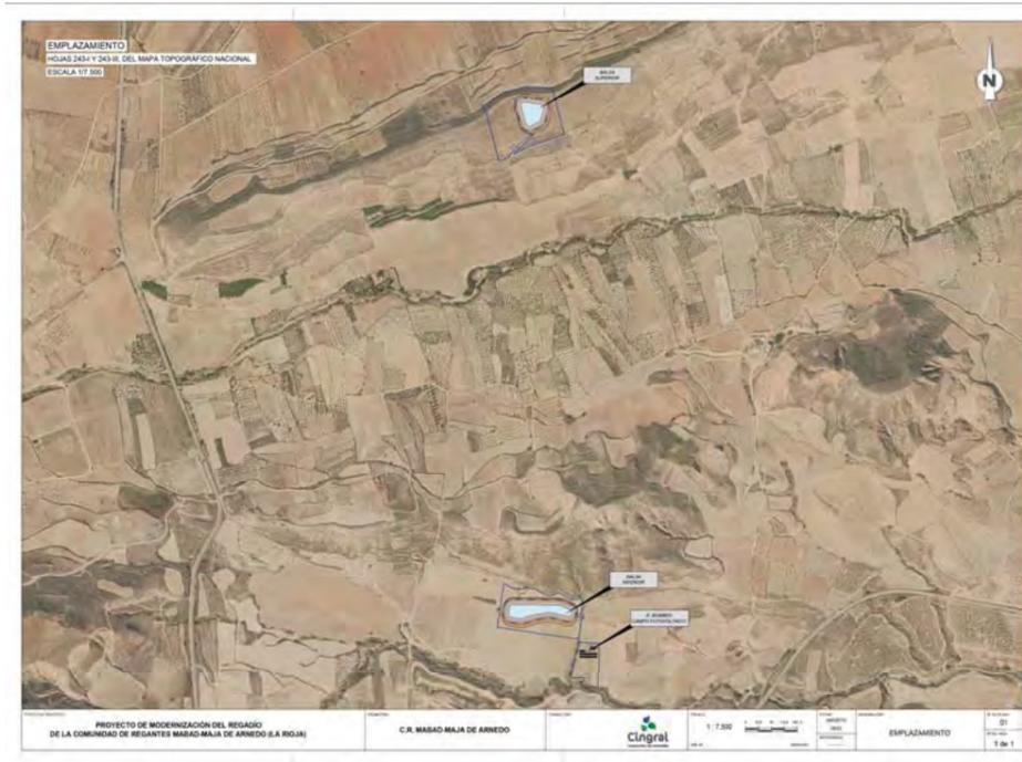
02 Ortofoto con indicación de las ubicaciones de la balsa superior, balsa inferior, estación de bombeo y campo fotovoltaico, únicos espacios prospectados por el momento. Facilitada por CINGRAL S.L.
