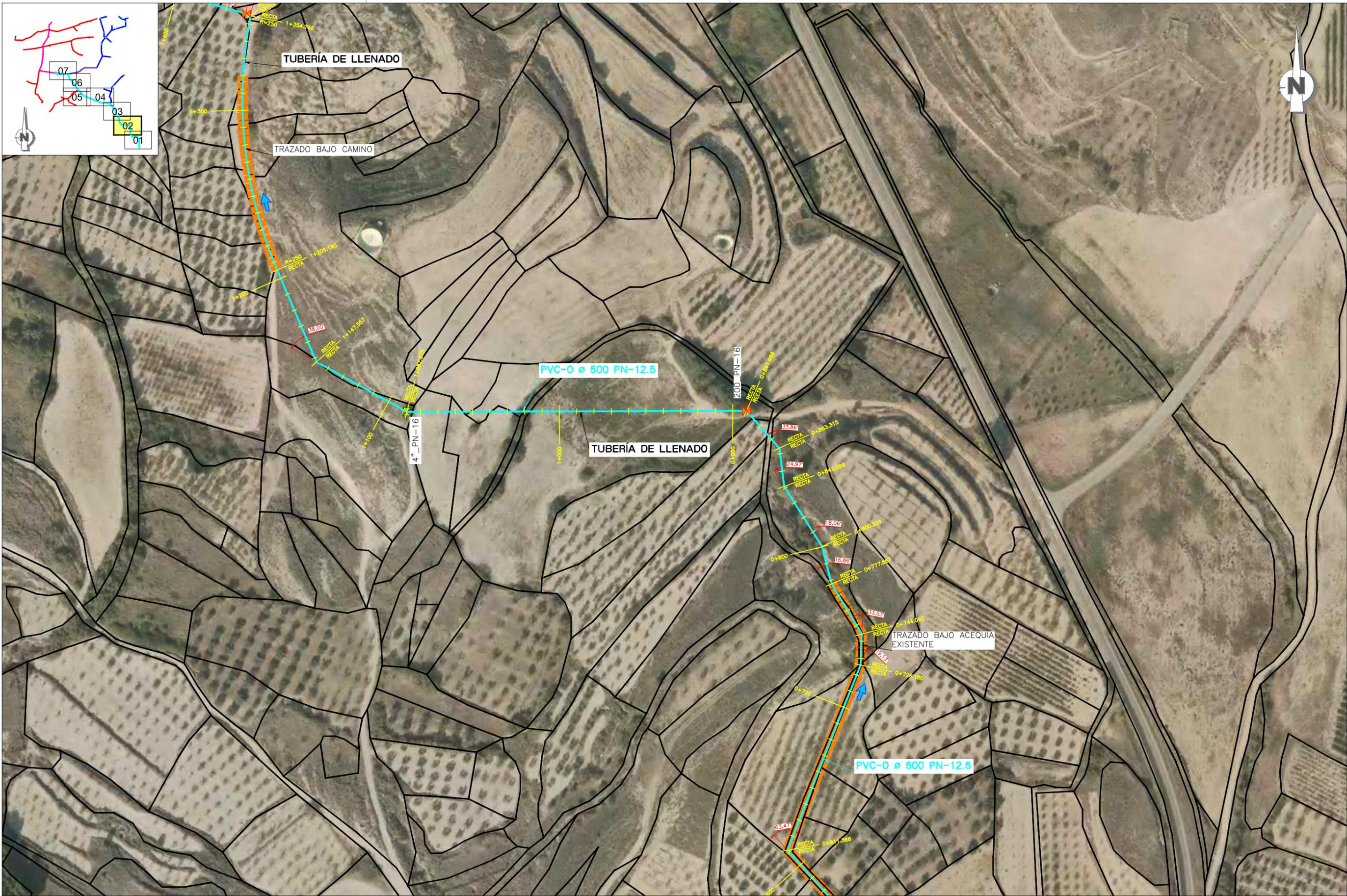
**LEYENDA**    — TUBERÍA DE LLENADO    — TUBERÍA RED DE RIEGO PISO BAJO    — TUBERÍA RED DE RIEGO PISO ALTO    VENTOSA    DESAGÜE    VALVULA DE SECCIONAMIENTO    SENTIDO DEL AGUA    ↔ PVC-0 ø PN    ↔ ESPECIFICACIONES TUBERIA
