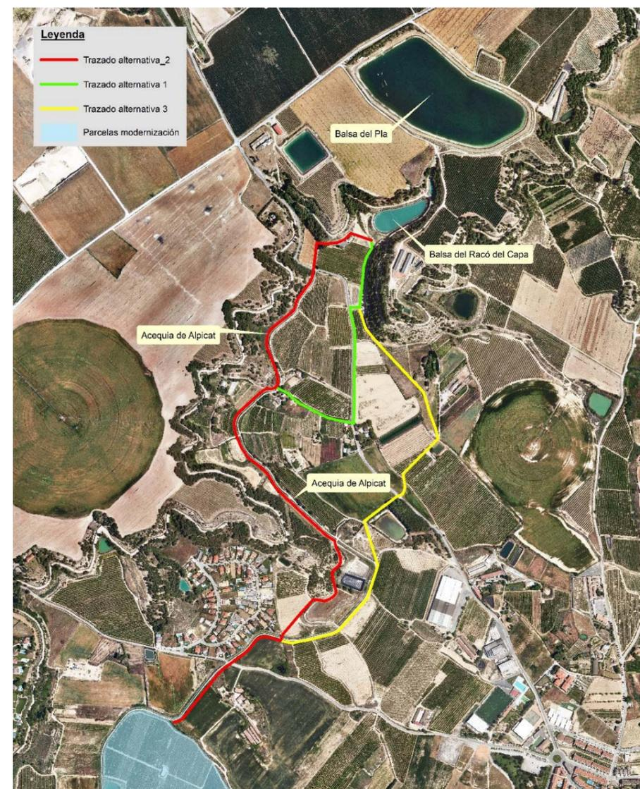
Figura 5. Esquema de las alternativas de trazado de red.
