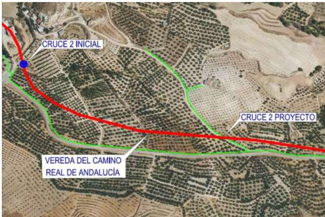
**Figura 26.** Cruce 2 de la red de riego con vía pecuaria en el proyecto de la Fase II y Cruce 2 previsto en la Documentación Ambiental
