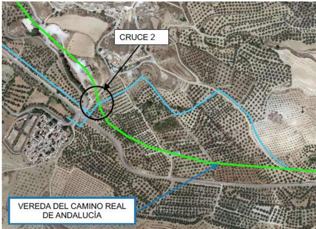
**Figura 25.** Cruce 2 de la red de riego con vía pecuaria
