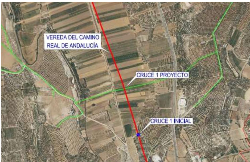
**Figura 24.** Cruce 1 de la red de riego con vía pecuaria recogido en el proyecto de la Fase II y Cruce 1 previsto en la Documentación Ambiental
