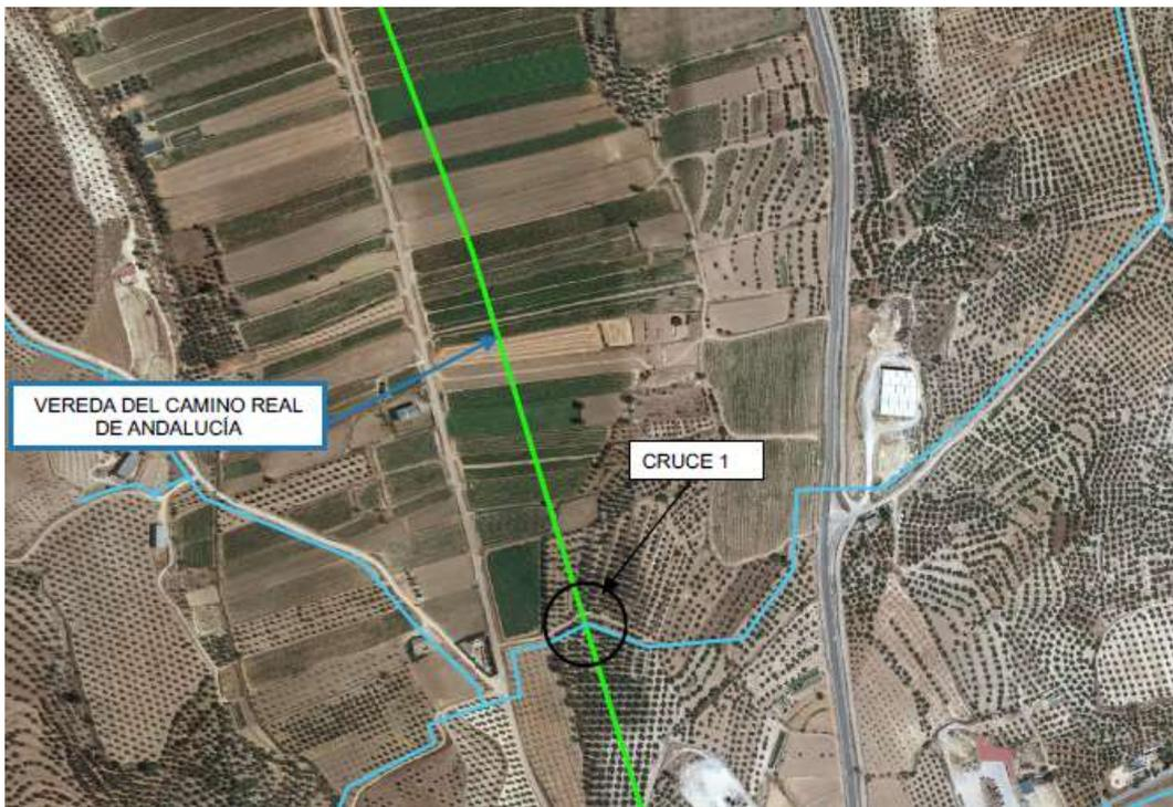
**Figura 23.** Cruce 1 de la red de riego con vía pecuaria recogido en la Documentación Ambiental
