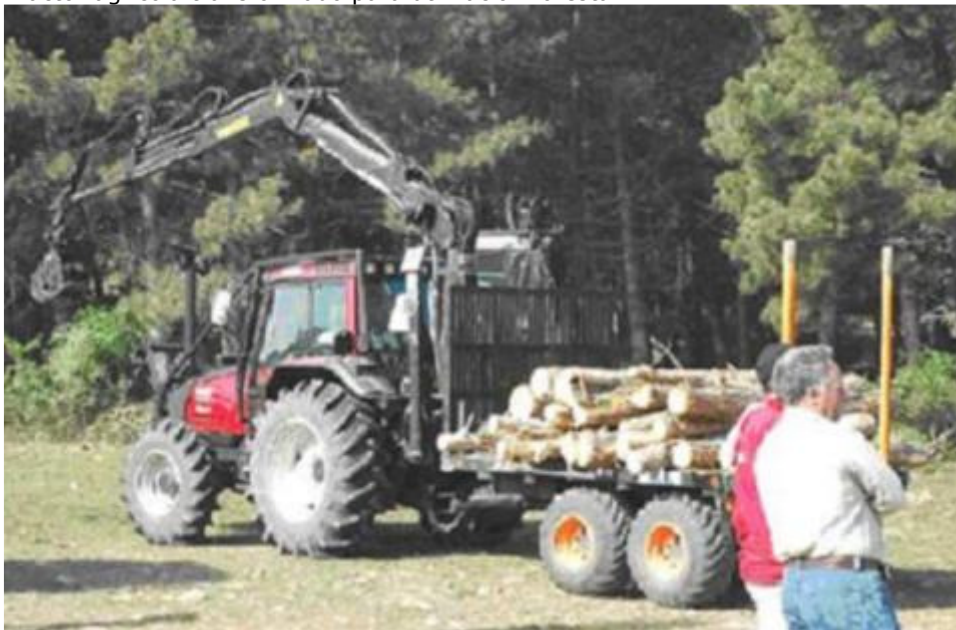
Tractor agrícola transformado para utilización forestal
