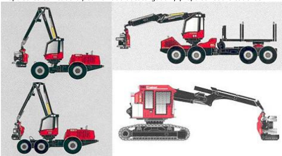
Propulsores con cabeza, combinado autocargador y propulsor sobre cadenas
