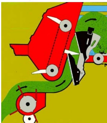
Alimentador con cuchillas para picado
