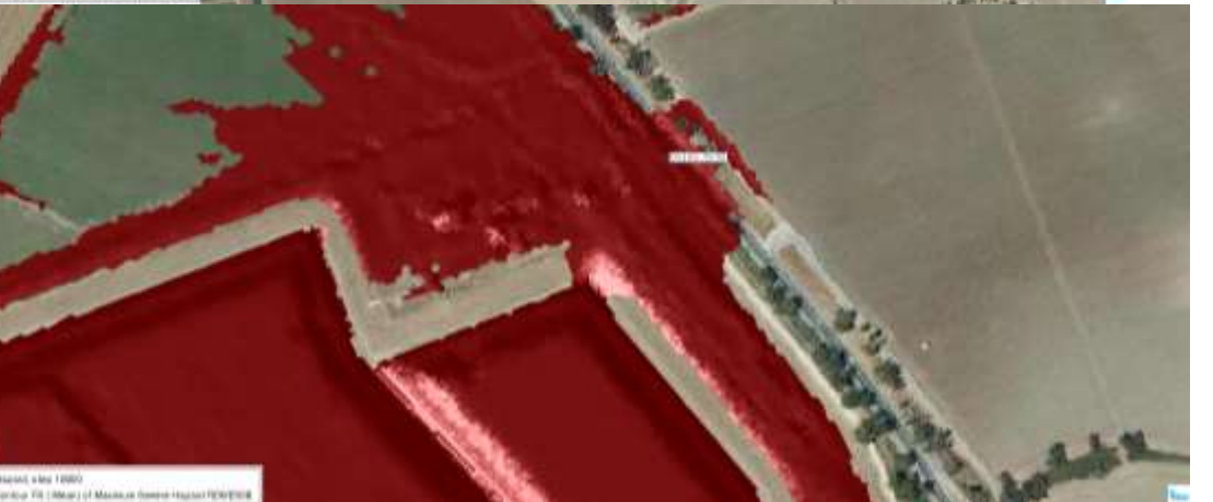
Imagen 58. Zonas de graves daños según criterio de RD9/2008 en rotura 4. Balsa sector Alcantarillas
