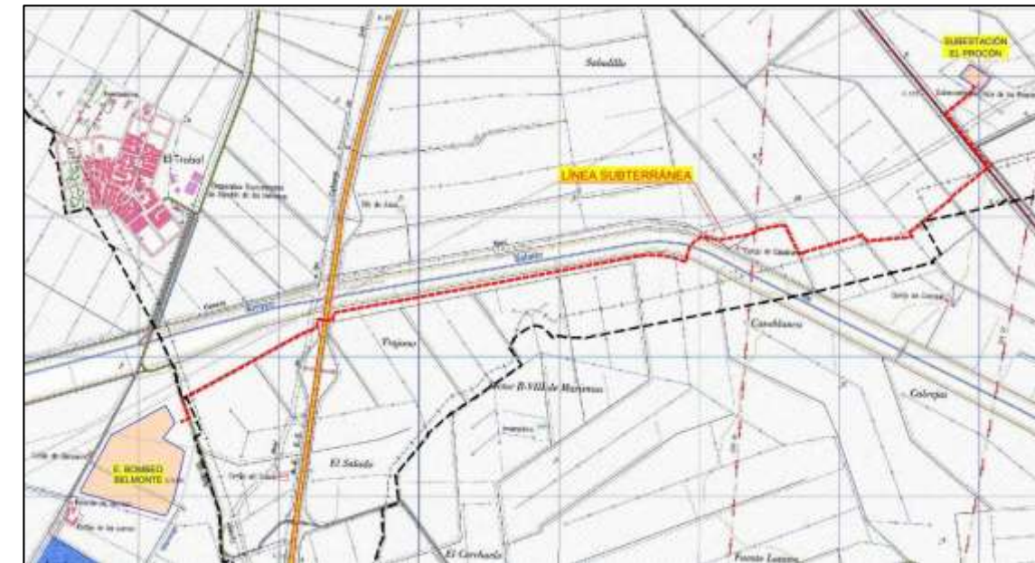
Imagen 3. línea subterránea, SE los Palacios – Belmonte
