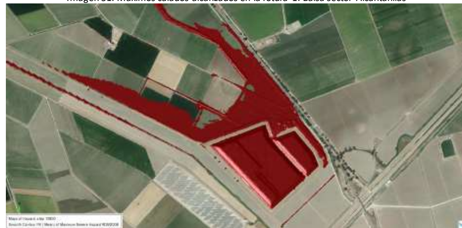
Imagen 52. Zonas de graves daños según criterio de RD9/2008 en rotura 1. Balsa sector Alcantarillas
