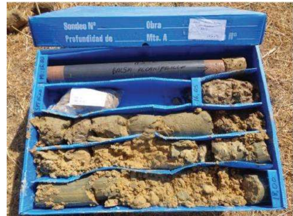
Imagen 20. Testigos del sondeo AS-2. Arena limosa con indicios de fragmentos de calcarenitas a 15 m de profundidad.
