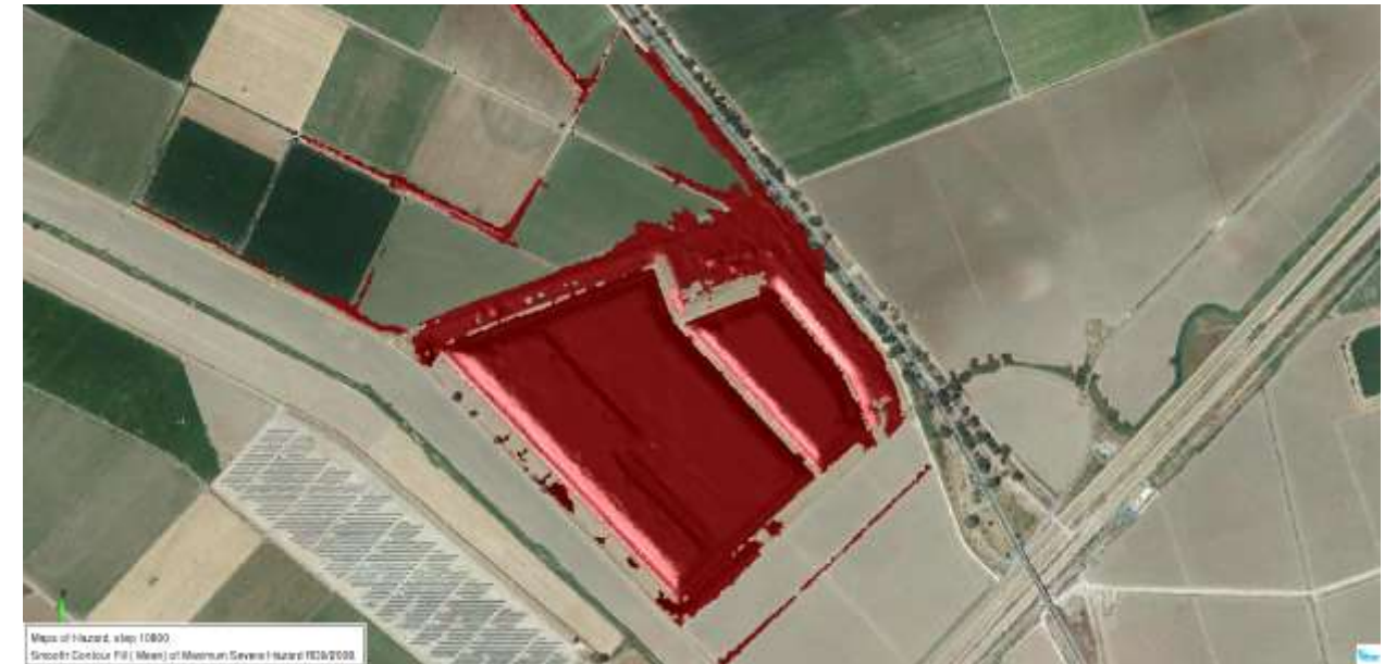
Imagen 60. Zonas de graves daños según criterio de RD9/2008 en estado actual. Balsa sector Alcantarillas
