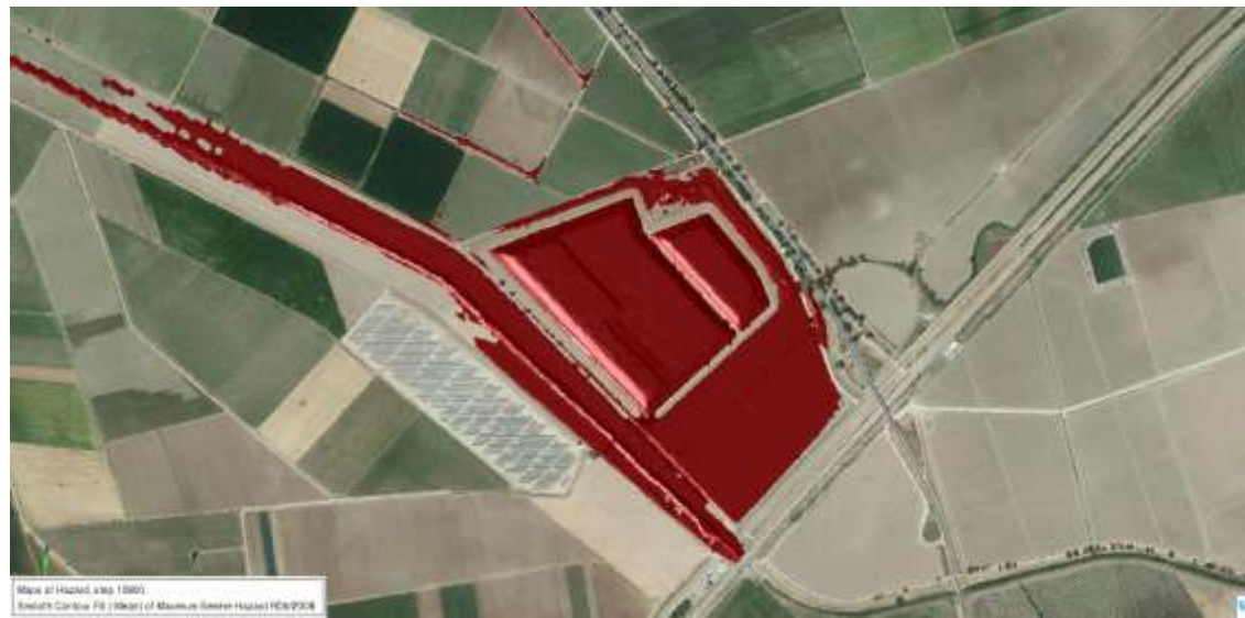
Imagen 65. Zonas de graves daños según criterio de RD9/2008 en rotura 6. Balsa sector Alcantarillas
