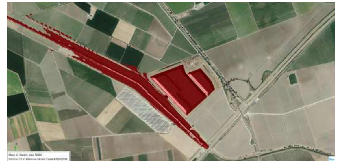
Imagen 63. Zonas de graves daños según criterio de RD9/2008 en rotura 5. Balsa sector Alcantarillas
