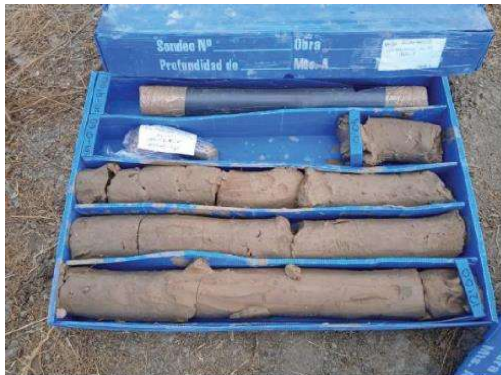
Imagen 21. Testigos del sondeo AS-1. Arcilla marrón claro con presencia de vetas limo-arenosas grises, a 10 m de profundidad.
