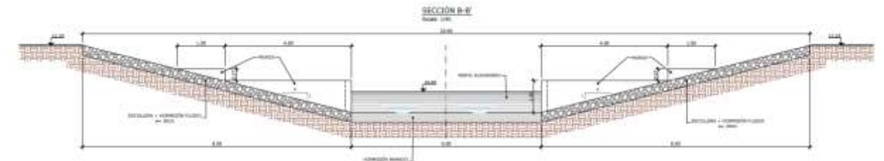
Figura 9: Aliviadero balsa de regulación. Alzado
