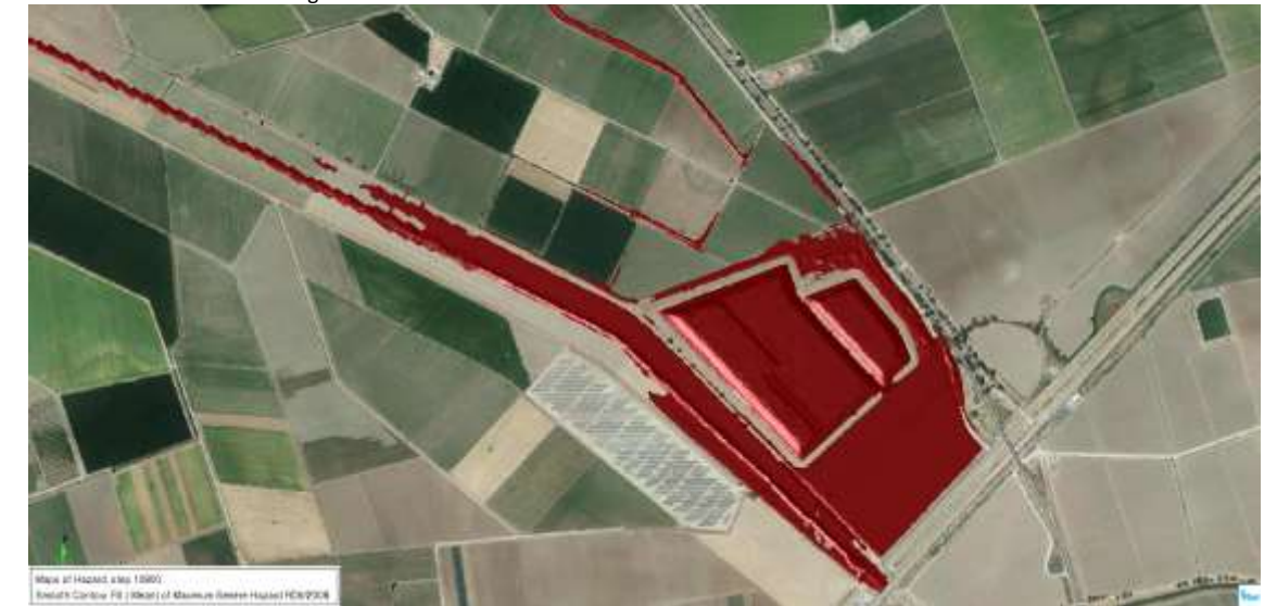
Imagen 54. Zonas de graves daños según criterio de RD9/2008 en rotura 2. Balsa sector Alcantarillas
