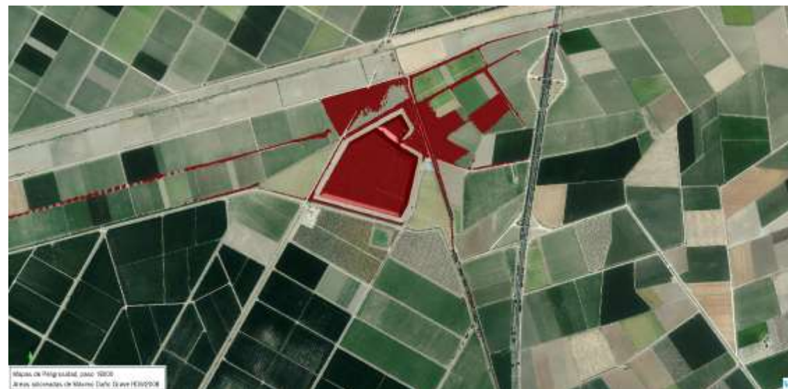
Imagen 45. Zonas de graves daños según criterio de RD9/2008 en rotura 1. Balsa sector Belmonte
