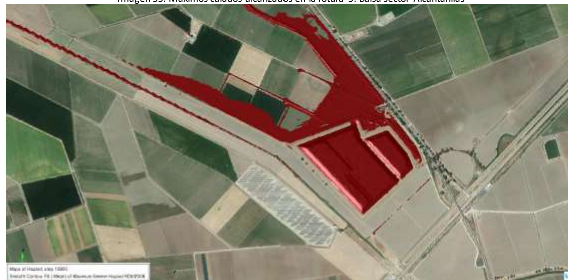
Imagen 56. Zonas de graves daños según criterio de RD9/2008 en rotura 3. Balsa sector Alcantarillas
