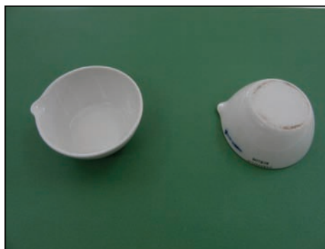
Pocillos cerámicos para la estimación de la Materia Orgánica por Ignición
