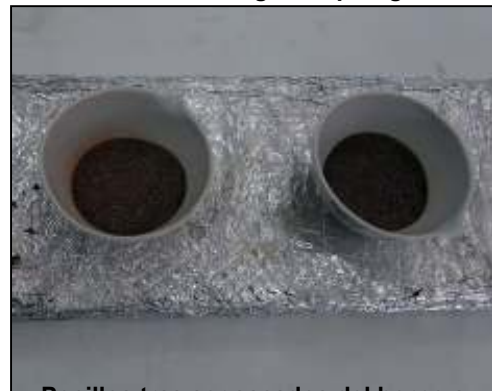
Pocillos tras ser sacados del horno a 450°C
