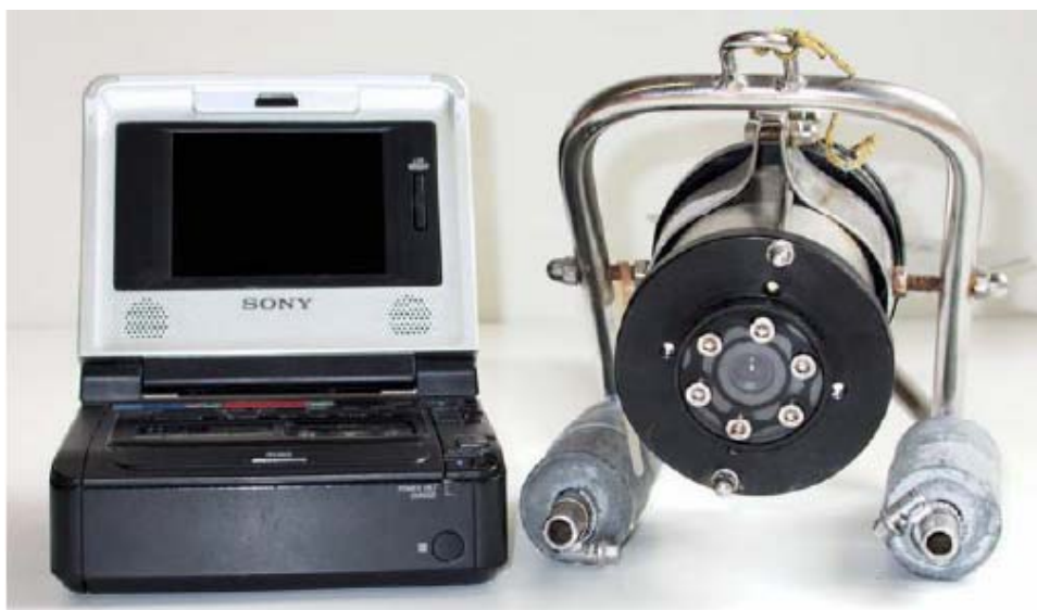
Figura 5: Sistema remoto de vídeo submarino por arrastre desde embarcación (Fuente: TAXON S.L. Gutiérrez et al., 2007).
