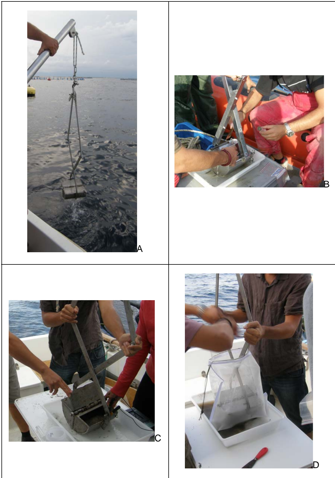
Figura 6: A) Toma de muestras con draga Van-Veen. B) Toma de submuestras para análisis de TFS. C) Medición de pH y Eh con electrodos directamente de la draga. D). Tamizado de muestras para estudio del poblamiento de poliquetos.
