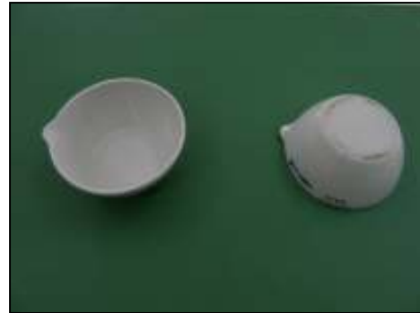
Pocillos cerámicos para la estimación de la Materia Orgánica por Ignición
