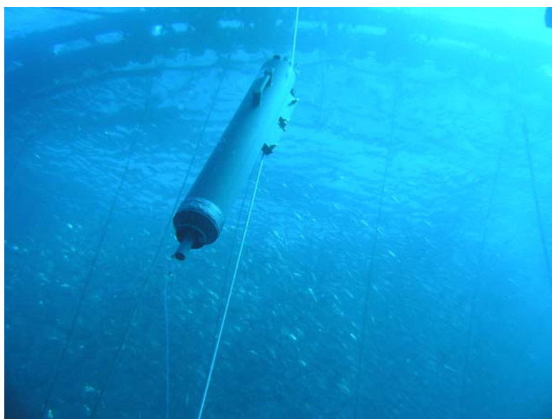
Figura 8: Botella hidrográfica Niskin para toma de muestras de agua a diferentes profundidades.
