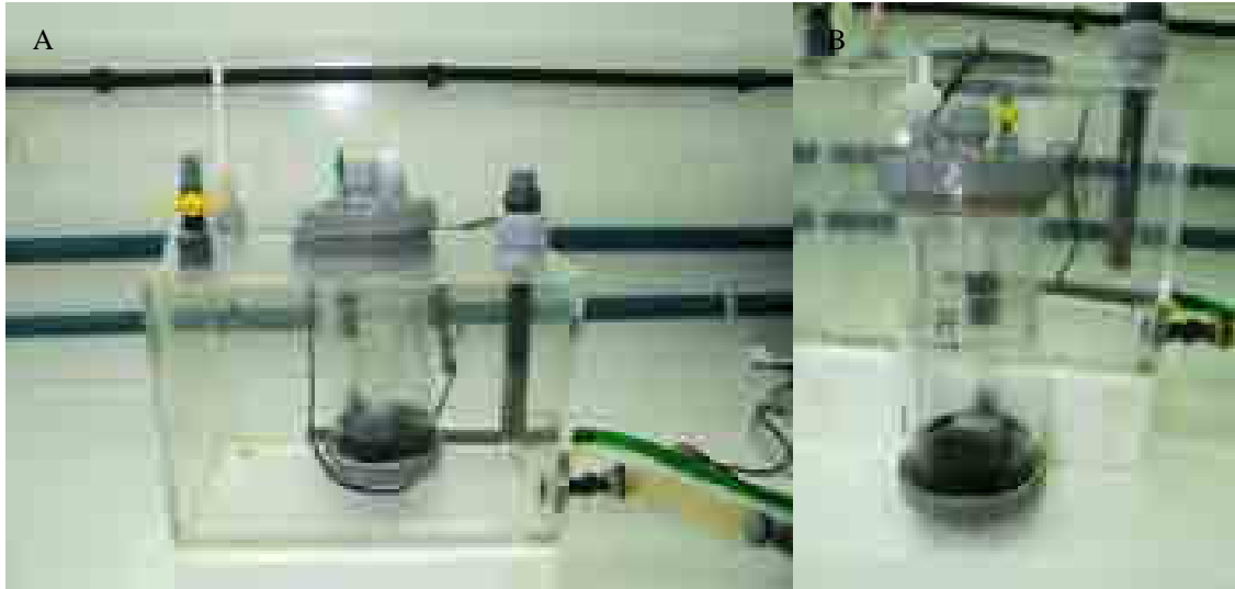
Fig. 39. Sistema para la medición de oxígeno en la semilla de S. marginatus . A. Cámara donde se recircula agua dulce para mantener la temperatura. B. Cámara estanca para la medición de oxígeno.
