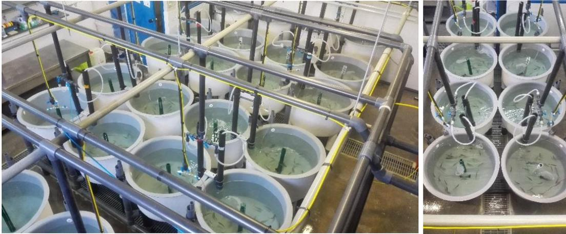
Figura 75. Unidad experimental (24 tanques) conectada a un sistema IRTAmar® donde se ha realizado la Tarea A.2.2.
