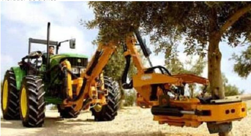
Cabezal de vibrador
