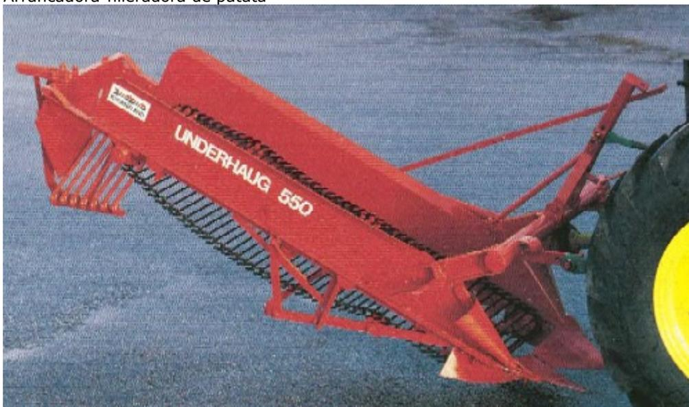
Cosechadora de patata integrada en el tractor
