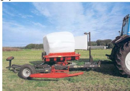
Combinación de rotoempacadora y envolvedora (fuera de la cámara)
