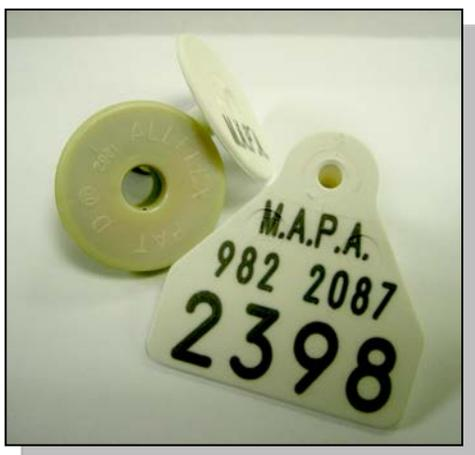
**Ilustración 6.** Crotal electrónico Azasa HDX
