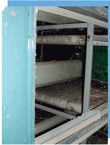
Imagen 1. Retirada de deyecciones mediante cinta transportadora.
