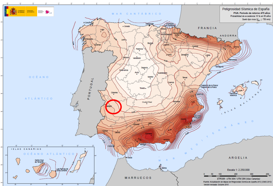
Figura 62. Mapa de peligrosidad sísmica de España en valores de aceleración. Fuente: IGN
