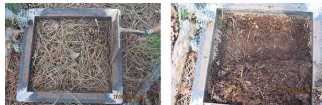
1. Colocación del bastidor de 30x30 cm. sobre el suelo y delimitación de del perímetro interior con una paleta. de albañil.
