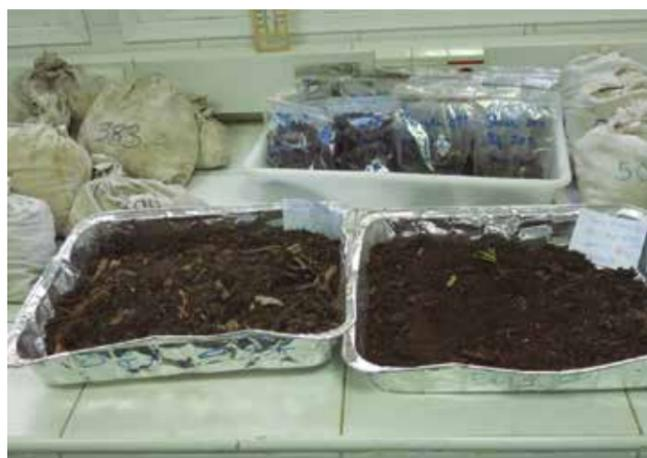
**Figura II.3.3.1.** Las muestras llegan al laboratorio debidamente identificadas se vierten en bandejas de aluminio para su secado al aire y se remueve la muestra para su homogeneización. A continuación se separa una submuestra en bolsas de polietileno que se seca a 65°C para la determinación del Carbono Orgánico total. El resto de la muestra se seca en estufa a 102°C para la determinación de Materia Seca (M.S)
