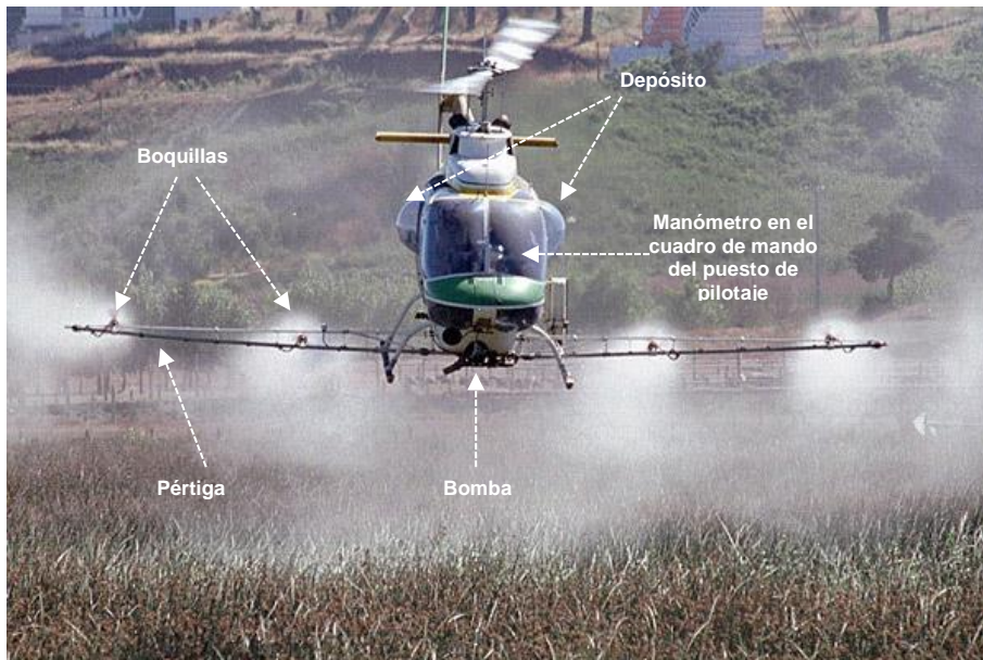
Figura 2. Elementos de un pulverizador aerotransportado sobre helicóptero.
