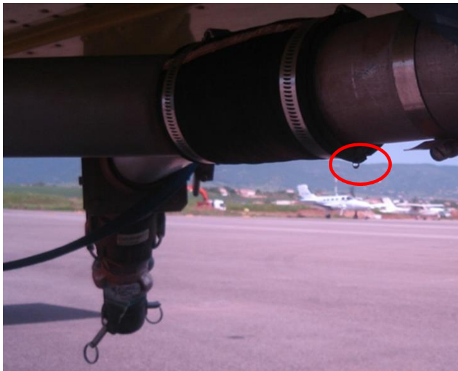
Junta de conexión entre tuberías con fugas apreciables
