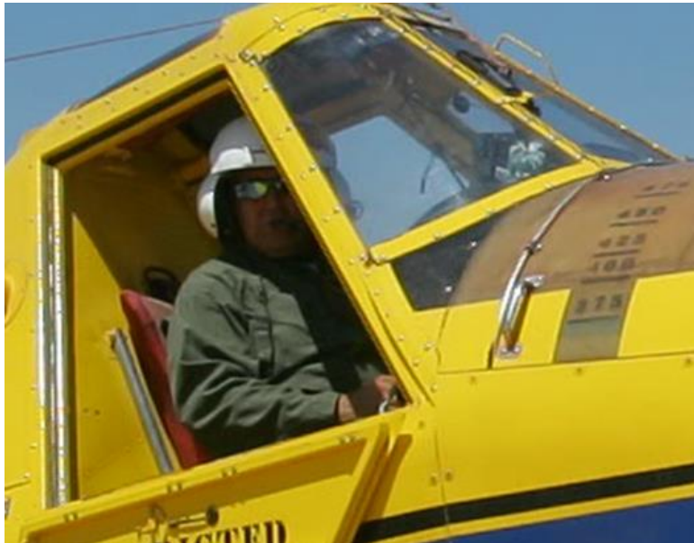
Indicador de nivel, de ventana translúcida, visible desde tierra para realizar el llenado al volumen adecuado
