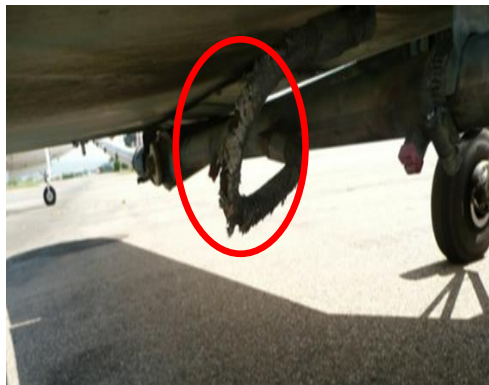
Tubería en mal estado que puede ocasionar fugas bajo presión del caldo
