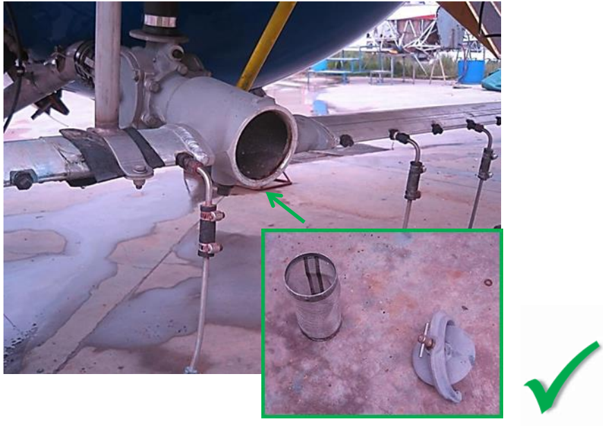
Filtro de impulsión fácil de extraer, limpiar e intercambiar por otro
