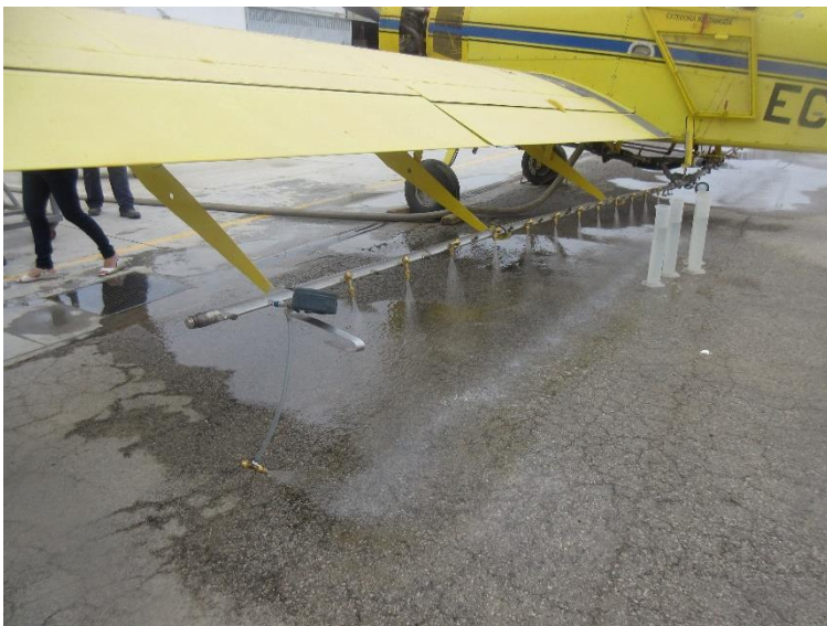
Medida del caudal con probetas graduadas
