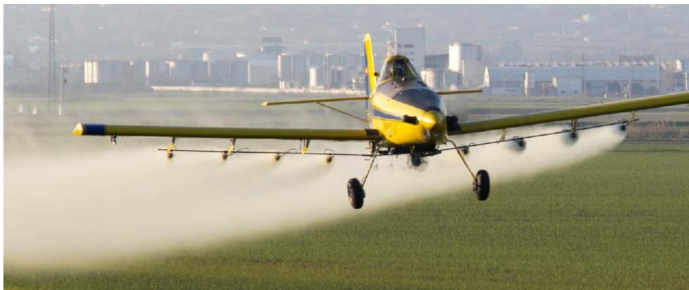
Simetría y equidistancia de boquillas en la barra (mismo número de boquillas en cada sección)
