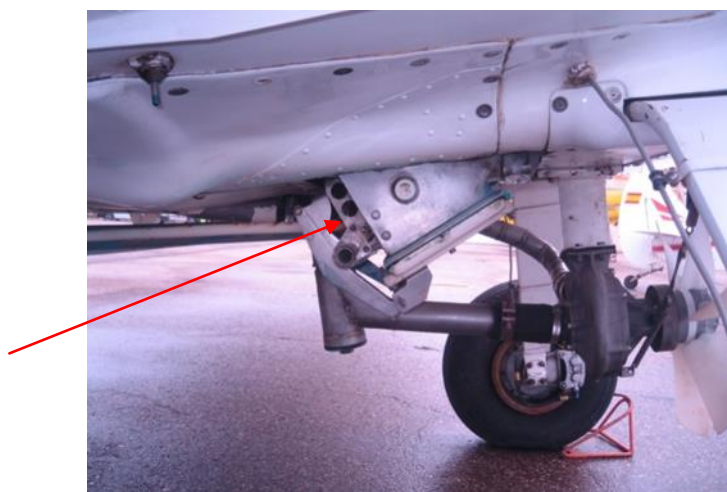
Trampilla de emergencia de vaciado sin fugas
