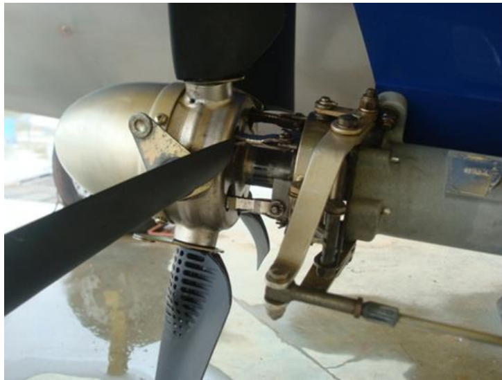
Sistema de desactivación del giro del molinete por modificación del ángulo de calado de las aspas
