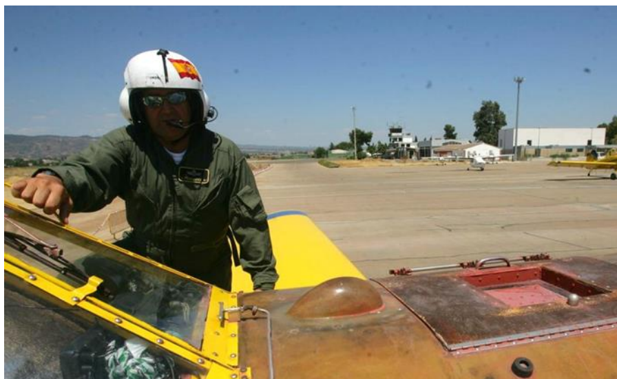
Comprobación del cierre estanco de la boca de llenado superior del depósito
