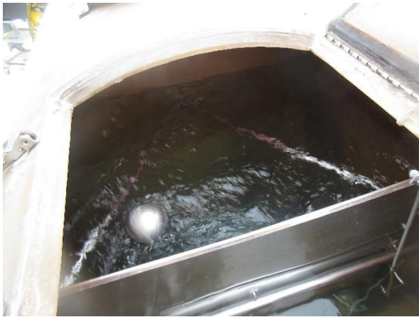
Agitación hidráulica claramente visible
