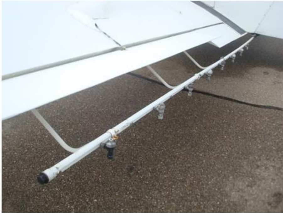
Pértiga con boquillas equidistantes para una pulverización uniforme separadas del ala del avión.
