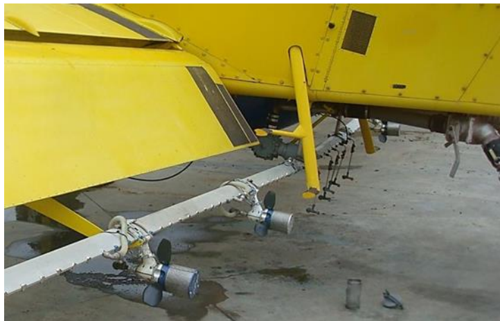
Boquillas centrífugas (accionadas por flujo de aire en la pértiga) y complementadas bajo la base de la aeronave (zona de interferencia de la bomba de molinete) por boquillas hidráulicas
