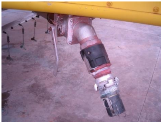
Válvula lateral de llenado del depósito sin fugas, pero con escape de líquido en el desacople
