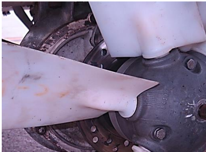
Comprobación del ángulo de calado de las palas en función de una posición señalada en la base. Todas las palas deben tener la misma posición
