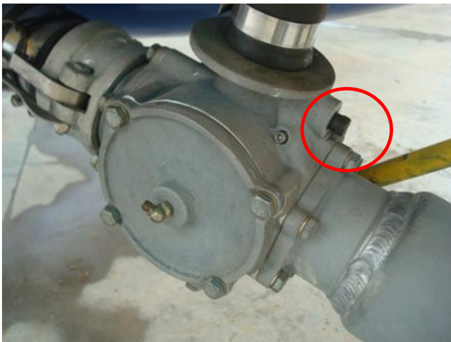
Válvula de tres vías sin fugas y con tuberías aprisionadas mecánicamente sin riesgo de fugas
