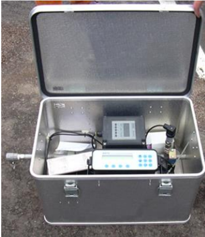
Caudalímetro para la medida del caudal de la bomba
