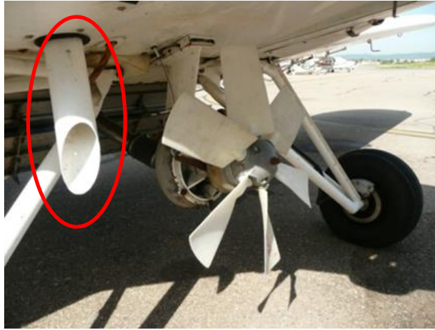
Dispositivo tubular de compensación de la presión interior del depósito
