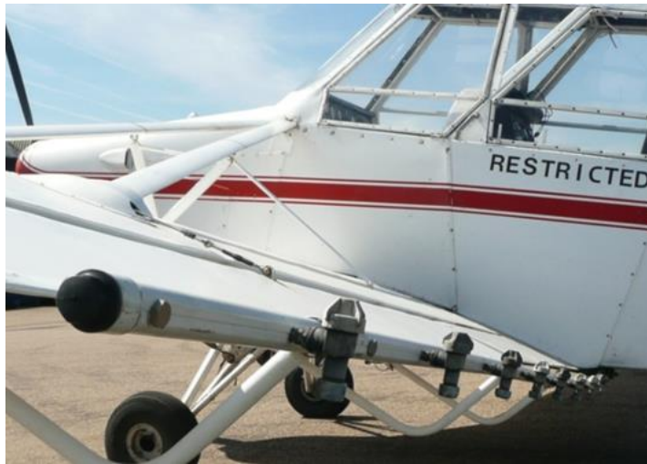
Boquillas hidráulicas idénticas en toda la pértiga
