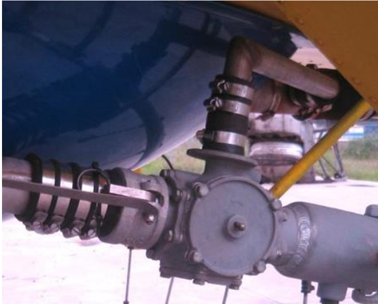
Válvula de tres vías sin fugas y con tuberías aprisionadas mecánicamente sin riesgo de fugas
