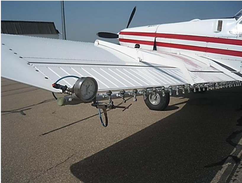
Comprobación de la caída de presión en el extremo de la pértiga con manómetro calibrado
