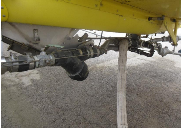
Válvula lateral durante la operación de llenado
