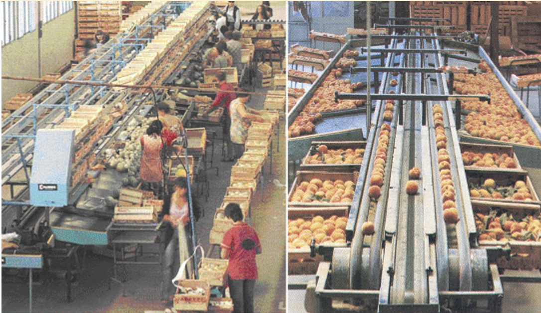
Instalación para la clasificación y calibración de frutas y hortalizas. Clasificación por cintas divergentes.
