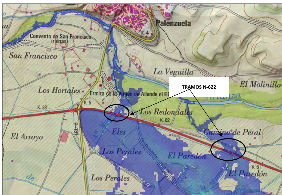
Llanura de inundación de la balsa de Palenzuela cuando rompe por la sección EF.
