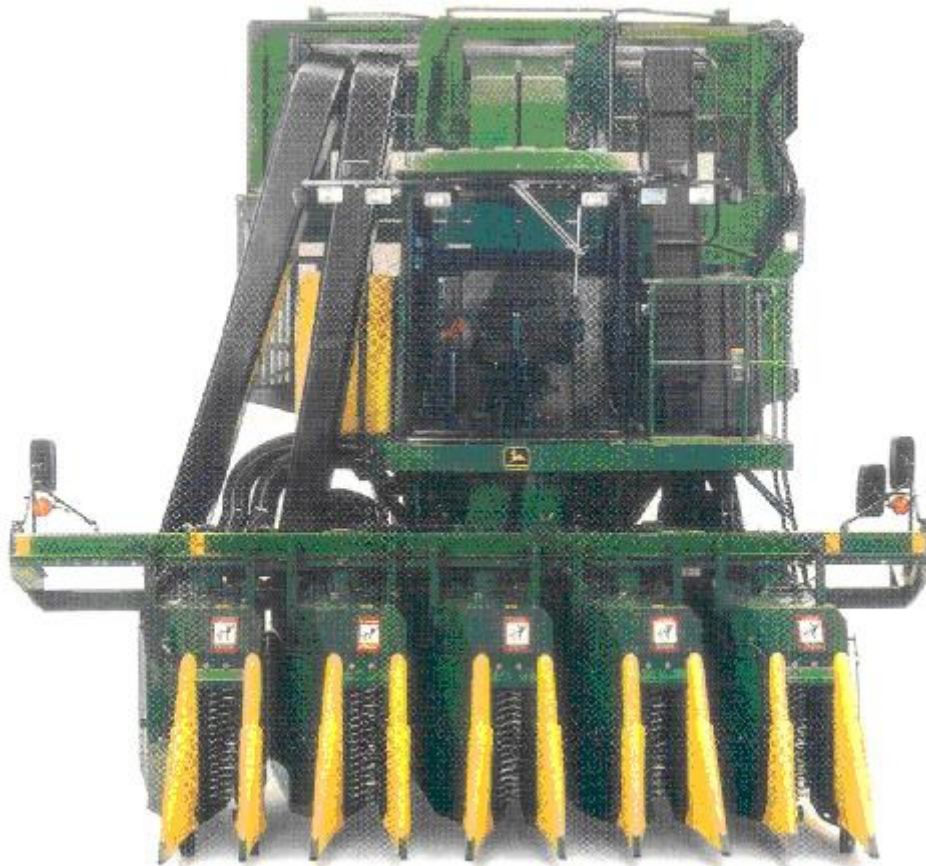
Cosechadora de algodón (fibra) autopropulsada para cinco líneas
