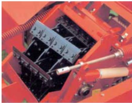
Detalle del tambor picador y dispositivo de seguridad frente a la entrada de piedras
