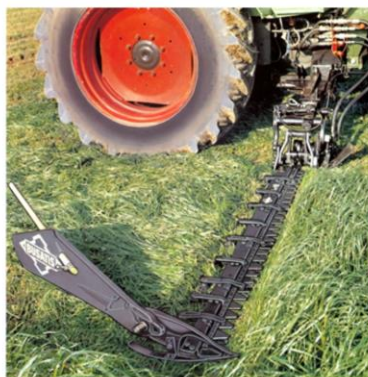
Doble cuchilla en movimiento alternativo (tipo "busatis")
