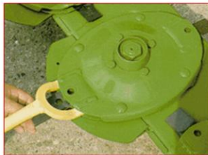
Fijación y cambio de cuchillas
