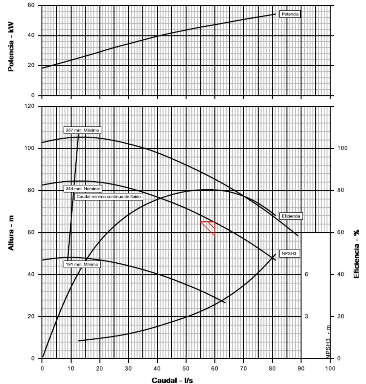
Se dimensiona un equipo de bombeo de cámara partida horizontal capaz de proporcionar 56 l/s a una altura de 65,22 m.c.a., accionados mediante motor eléctrico de 55 kW, 50 Hz 400 V a 2.9800 rpm, accionado por variador de frecuencia híbrido específico para funcionamiento solar. Además deberá ser capaz de cubrir el rango entre los 11,5 l/s y los 56 l/s previstos con rendimientos de acuerdo a la curva anterior.
