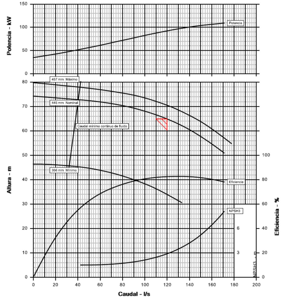
Se dimensiona un equipo de bombeo de cámara partida horizontal capaz de proporcionar 120 l/s a una altura de 65,22 m.c.a., accionados mediante motor eléctrico de 132 kW, 50 Hz 400 V a 1.490 rpm, accionado por variador de frecuencia híbrido específico para funcionamiento solar. Además, deberá ser capaz de cubrir el rango entre los 40 l/s y los 120 l/s previstos con rendimientos de acuerdo a la curva anterior.
