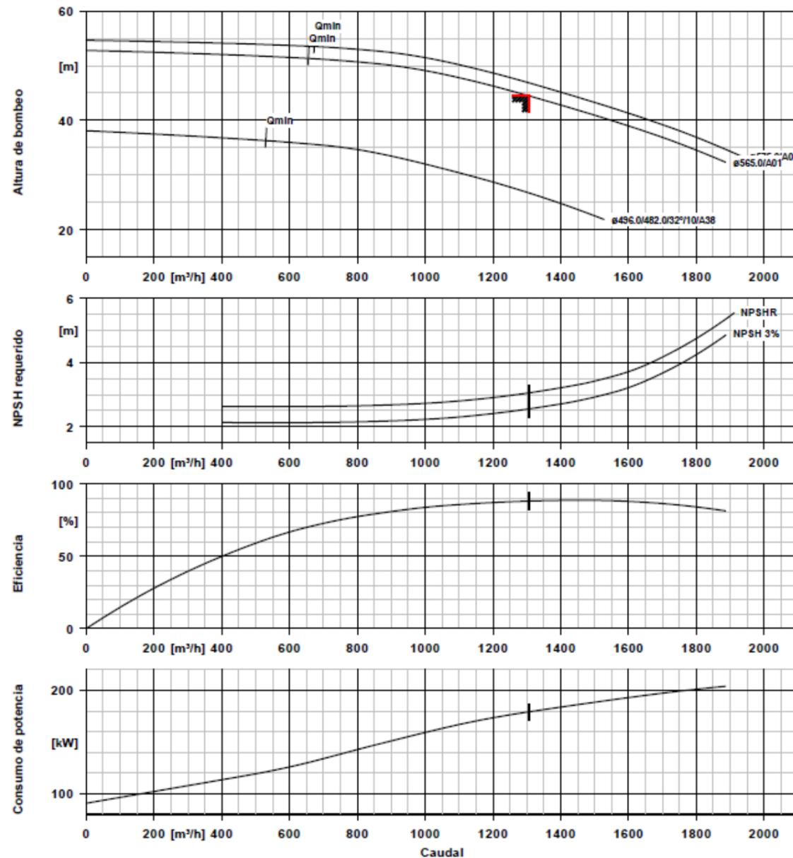
Se dimensiona un equipo de bombeo cámara partida capaz de proporcionar 363 l/s a una altura de 44,5 m.c.a., accionados mediante motor eléctrico de 200 kW, 50 Hz 400 V a 993 rpm, accionado por variador de frecuencia híbrido específico para funcionamiento solar. Además, deberá ser capaz de cubrir el rango entre los 181,1 l/s y los 363 l/s previstos con rendimientos de cuerdo a la curva anterior.
