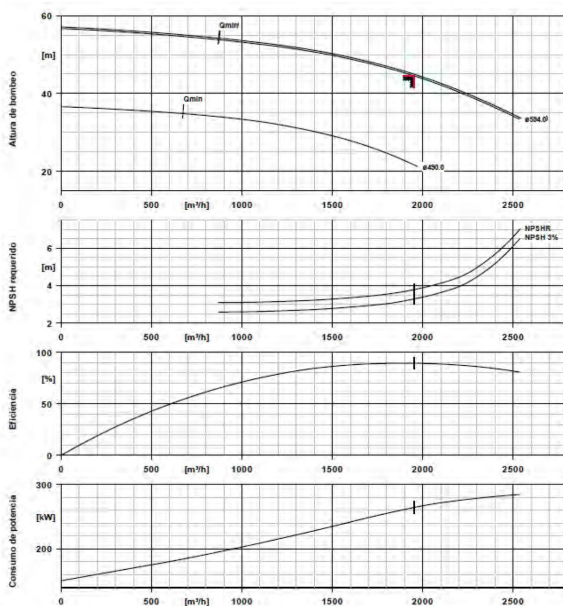
Se dimensiona un equipo de bombeo cámara partida capaz de proporcionar 543 l/s a una altura de 44,5 m.c.a., accionados mediante motor eléctrico de 315 kW, 50 Hz 400 V a 994 rpm, accionado por variador de frecuencia híbrido específico para funcionamiento solar. Además, deberá ser capaz de cubrir el rango entre los 363 l/s y los 543 l/s previstos con rendimientos de cuerdo a la curva anterior.
