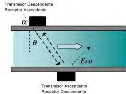
En todos los casos son equipos no intrusivos para la medición por el exterior de la tubería, mediante los sensores adecuados. El fluido será homogéneo y limpio. El rango de medida de velocidad del agua por los sensores externos será entre 0,3 a 15 m/s. El rango de temperaturas del fluido de funcionamiento de los sensores será hasta 80 °C. La protección ambiental de los equipos será IP-67.
