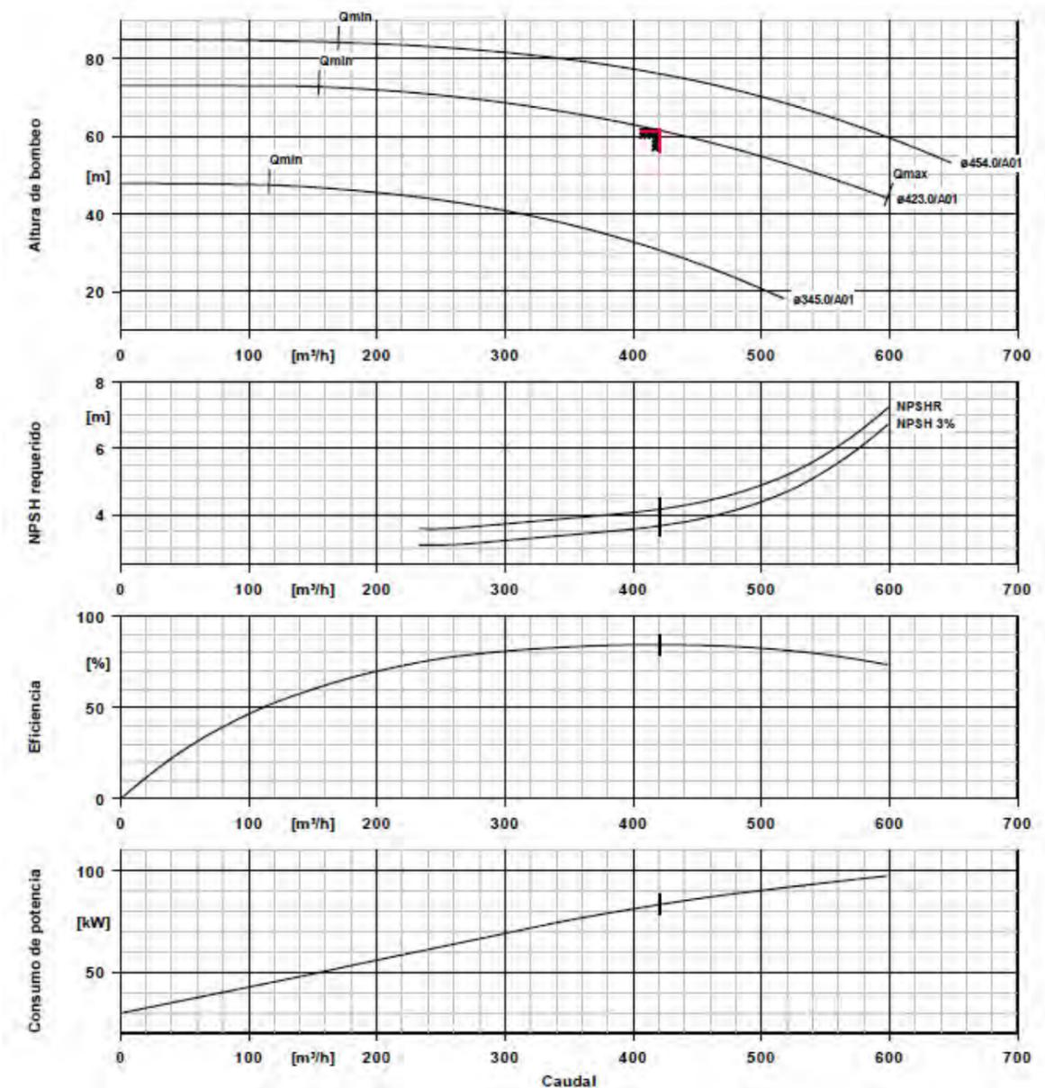
Se dimensiona un equipo de bombeo cámara partida capaz de proporcionar 116,94 l/s a una altura de 62,0 m.c.a., accionados mediante motor eléctrico de 110 kW, 50 Hz 400 V a 1.490 rpm, accionado por variador de frecuencia híbrido específico para funcionamiento solar. Además, deberá ser capaz de cubrir el rango entre los 41,67 l/s y los 116,94 l/s previstos con rendimientos de cuerdo a la curva anterior.
