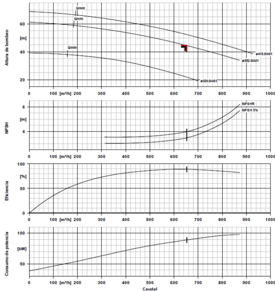
Se dimensiona un equipo de bombeo cámara partida capaz de proporcionar 181,1 l/s a una altura de 44,5 m.c.a., accionados mediante motor eléctrico de 110 kW, 50 Hz 400 V a 1.490 rpm, accionado por variador de frecuencia híbrido específico para funcionamiento solar. Además, deberá ser capaz de cubrir el rango entre los 47,2 l/s y los 181,1 l/s previstos con rendimientos de cuerdo a la curva anterior.
