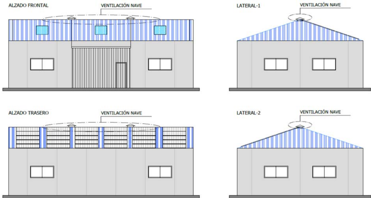
Acabados exteriores estación de bombeo
