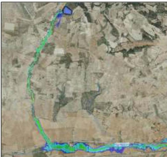
La brecha 3 vierte directamente al cauce innominado, lo que hace que la onda de rotura vaya totalmente encauzada hasta llegar al Río Madre. El cruce de este arroyo bajo la carretera N-III se produce mediante obras de drenaje insuficientes para el caudal de rotura, por lo que se produce la inundación y la afección grave de la N-III.
