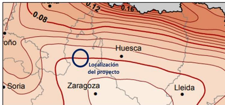
Figura 80. Detalle de peligrosidad sísmica en la ubicación del área del proyecto. Fuente: Mapas de sismicidad y peligrosidad IGN.
