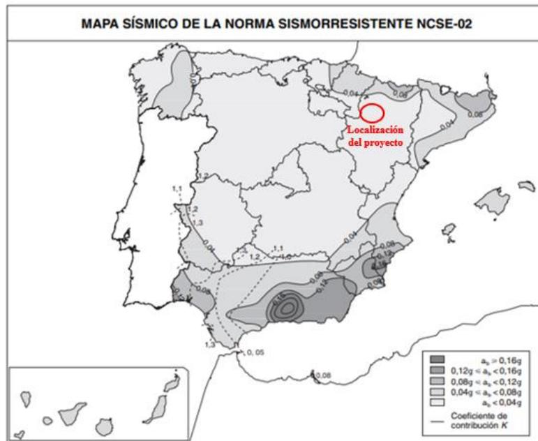
Figura 78. Mapa sísmico de España (NCSE-02). Fuente: Norma de Construcción Sismorresistente: Parte general y edificación (NCSE-02). Ministerio de Fomento.
