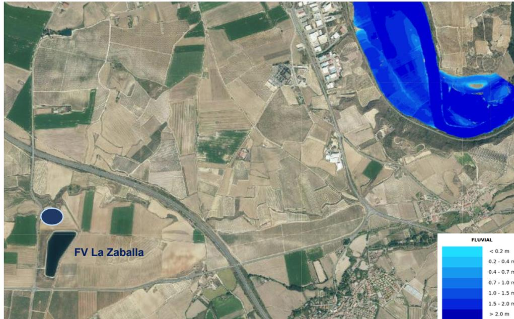
Figura 86. Mapa de peligrosidad de inundación fluvial para la planta fotovoltaica La Zaballa. Demarcación Hidrográfica del Ebro.
